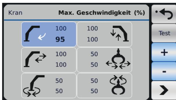
Die Werte können über das Display eingestellt werden. Bewegung und Richtung durch Drücken auf das Symbol aktivieren, danach die blauen AUF oder AB Pfeile drücken, um den Wert einzustellen, Ausgewählte Bewegung durch Drücken der Taste Zurück oder des Symbols verlassen.
