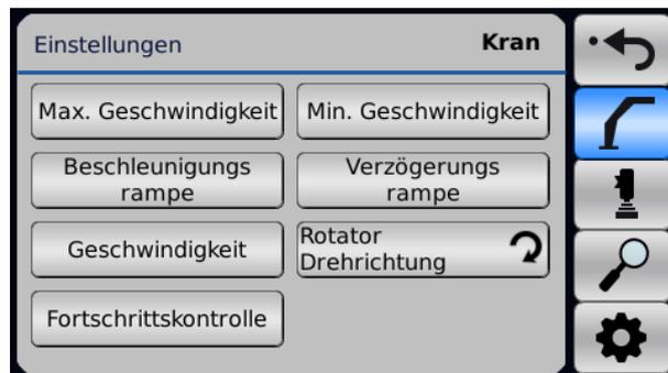
Es ist möglich, die Drehrichtung des Rotators zu ändern. Die Änderung wird durch Drücken der Taste vorgenommen. Der Pfeil zeigt die Rotatorrichtung an.
