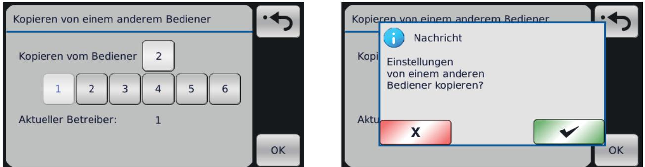
Durch Drücken der Taste OK werden die Parameter vom ausgewählten Fahrer zum aktuellen kopiert. Danach folgt das Pop-up.
