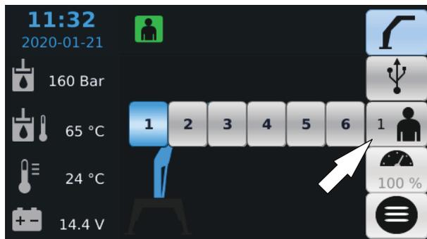
Le menu de sélection du pilote peut être activé en appuyant sur le bouton situé du côté droit de la vue de travail. Il y a six opérateurs dans le système, et chaque opérateur peut avoir son propre ensemble de paramètres.
