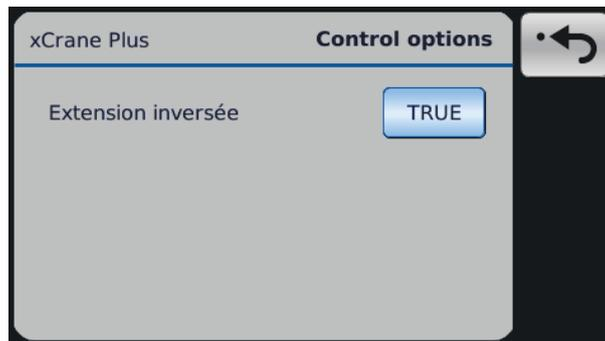
On modifie les paramètres du mode d'utilisation en appuyant sur les boutons à côté du nom du paramètre.
