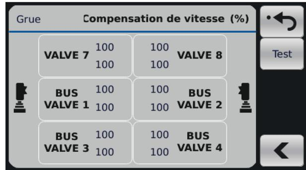
Les paramétrages de compensation de vitesse permettent de définir la vitesse relative entre chaque fonction de grue lors de l'ajustement de la vitesse de la grue en utilisant la fonction Technion Quick Trim dans la vue de travail. Dans cet exemple, l'opérateur veut que les fonctions de grappin soient aussi rapides que possible en toutes situations.
