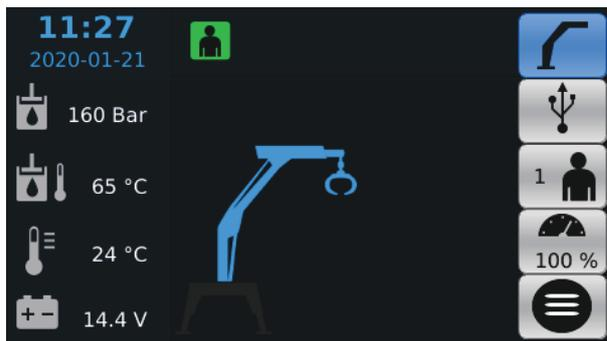
La vue de travail permet à l'utilisateur de changer l'opérateur, la vitesse de cet opérateur, et le mode de fonctionnement. Les données des capteurs sont disponibles du côté gauche de la vue de travail. Dans la barre du haut, certaines icônes relatives au système sont disponibles. La configuration du système par le fabricant de la grue définit quelles icônes sont visibles dans la vue de travail.
