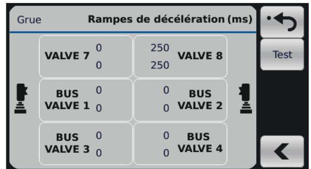
Les rampes de décélération définissent la vitesse avec laquelle les valeurs de contrôle passent de vitesse max. à vitesse min. Plus la valeur des rampes est élevée, plus il faudra longtemps à la valeur de contrôle pour passer de vitesse max. à vitesse min. Définir les rampes de décélération de sorte que les mouvements de la grue soient fluides sans l'apparition de longs délais de contrôle.
