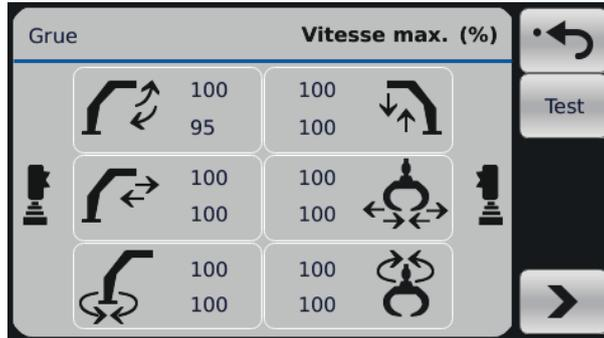
Pour sélectionner la fonction que vous voulez ajuster, activer la fonction désirée en utilisant le levier de commande. L'icône de la fonction sélectionnée deviendra bleue et à côté du levier de commande opposé apparaîtront les symboles - et +. Utiliser l'axe Z du levier de commande opposé pour augmenter ou réduire une valeur. Une fois que vous avez défini la bonne valeur, vous pouvez revenir au sous-menu ou commencer à ajuster une autre fonction.
