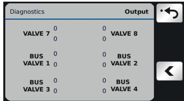
Cet écran affiche les signaux de contrôle relatif à la vanne. Utiliser les flèches pour parcourir les paramètres de la vanne auxiliaire et de la vanne de grue.
