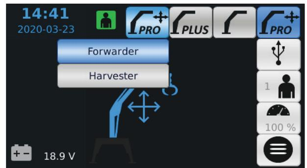
On active la sélection du mode de contrôle de la grue en appuyant sur le bouton situé du côté droit de la vue de travail. Les modes qui peuvent être sélectionnés dépendent de la configuration du système du fabricant de la grue. Le mode de contrôle actif est affiché sur le bouton de sélection de mode.
