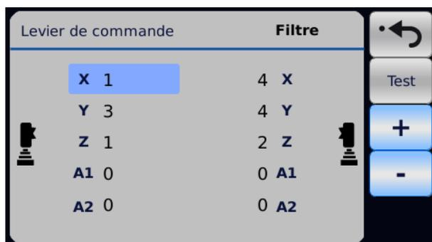
Il est aussi possible d'ajuster les valeurs des paramètres du levier de commande via l'affichage. On sélectionne l'axe en appuyant sur l'icône du levier de commande. Chaque pression change le canal. On modifie la valeur en appuyant sur les boutons bleus « haut » et « bas ». Quitter l'ajustement du canal actif en appuyant sur l'icône de levier de commande ou en appuyant sur le bouton retour.
