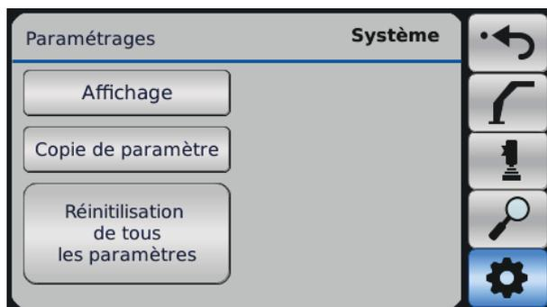
Dans le menu Paramétrages, le sous-menu Système se trouve sous le symbole d'engrenage.
