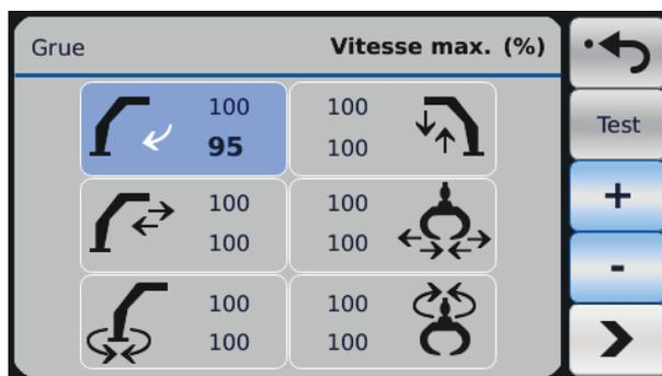
Il est aussi possible d'ajuster les valeurs via l'affichage. Activer le mouvement et la direction en appuyant sur l'icône, puis appuyer sur les flèches « haut » ou « bas » pour ajuster la valeur. Quitter le réglage du mouvement sélectionné en appuyant sur le bouton « Retour » ou en appuyant sur l'icône.
