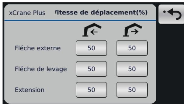
Le mode PLUS ne comporte pas de capteurs en temps réel et n'est pas en mesure de calculer la position des flèches. Les cylindres sont actionnés avec les vitesses définies, et si un cylindre atteint la position entièrement rentrée ou entièrement sortie, le système xCrane ne le sait pas.
