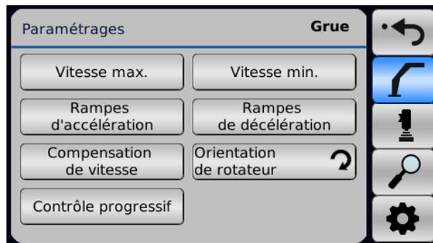
Il est possible de changer l'orientation du rotateur. On effectue ce changement en appuyant sur le bouton. La flèche indique la direction du rotateur.
