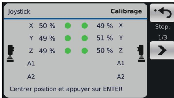
Laisser les leviers de commande en position centrale et appuyer sur « Suivant ». Un point vert en regard de la valeur du levier de commande indique que le canal actuel est OK.
