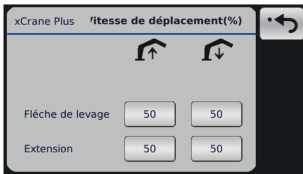
Le mode de contrôle extension/levage est disponible si le contrôle d'extension automatique est activé.
