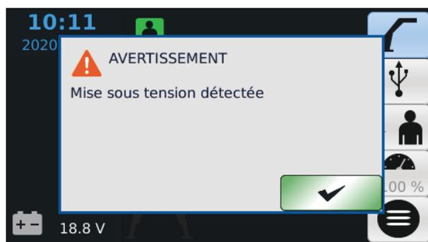
Si une situation de sous-tension se produit, tous les mouvements de la grue s'arrêteront. Le système devrait se rétablir de cette situation et le travail peut continuer en plaçant les leviers de commande au centre. La lecture de la fenêtre contextuelle peut être confirmée en appuyant sur le bouton OK.
