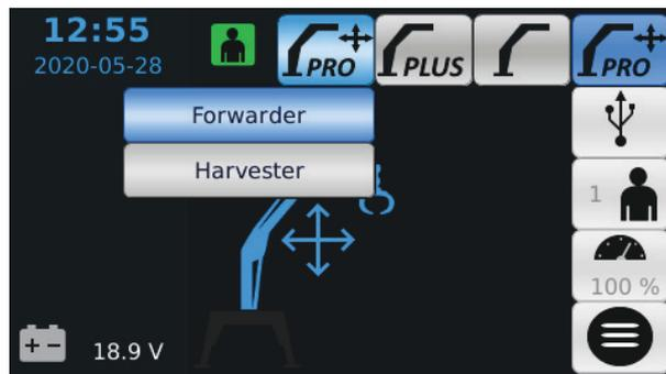
On sélectionne le mode de contrôle préréglé en appuyant sur le bouton portant le nom du mode préréglé désiré.
