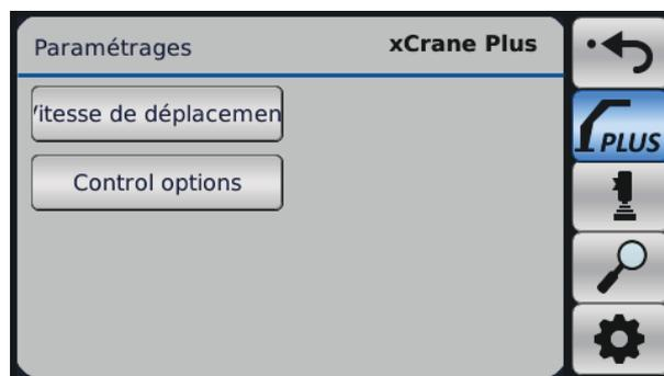
Le contrôle xCrane PLUS est un mode de contrôle où le système commande plusieurs mouvements de grue en même temps. Cette fonction permet de déplacer la grue comme une flèche parallèle, sans la barre parallèle.
