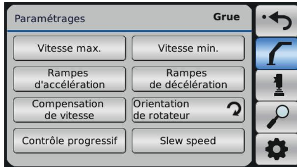
Dans le menu Paramétrages, vous pouvez accéder au sous-menu Grue sous le symbole de flèche, sélectionné dans l'image ci-dessus.
