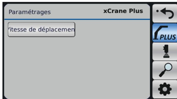
Si le mode xCrane PRO est activé depuis la sélection de mode de la vue principale, l'opérateur peut basculer les menus entre xCrane normal et xCrane PRO en utilisant le bouton comportant le symbole de flèche.
