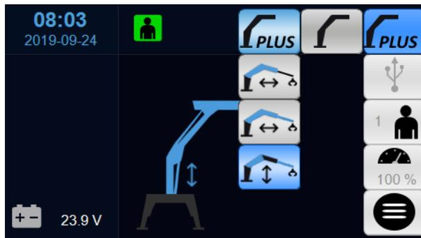
Ce mode permet à l'opérateur de contrôler la flèche de levage et la flèche d'extension en même temps. La flèche secondaire est contrôlée de façon manuelle.
