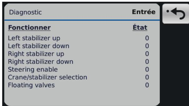
Les pages de diagnostic indiquent le statut des entrées du système. L'état de l'entrée change entre 0 et 1 si le bouton ou l'interrupteur fonctionne correctement.
