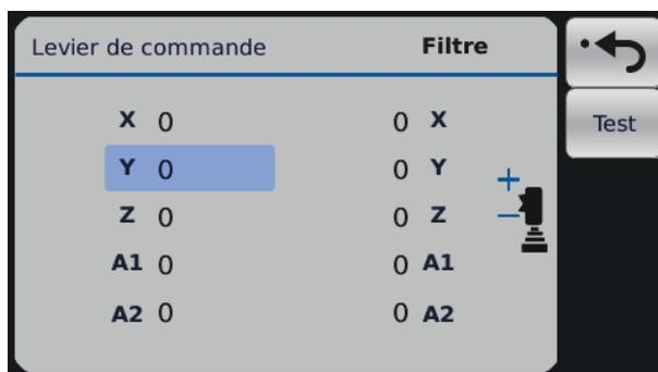
L'ajustement des paramètres du joystick fonctionne de la même manière que l'ajustement des paramètres de vanne. Choisir d'abord le canal à ajuster puis changer la valeur à l'aide de l'axe Z du levier de commande du côté opposé.
