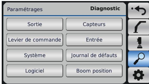
Dans le menu Paramétrages, le sous-menu Diagnostic se trouve sous le symbole de loupe. Le diagnostic permet à l'utilisateur de vérifier différentes parties du système xCrane.
