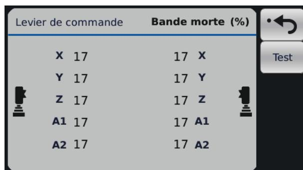
Les paramètres Bande morte définissent combien le levier de commande doit bouger par rapport au point central pour activer un mouvement. Cette
