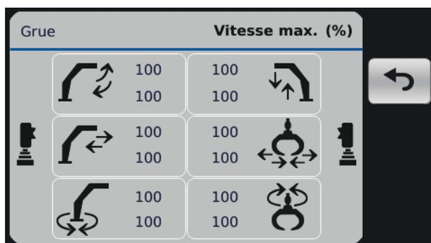
L'opérateur peut tester les valeurs ajustées en appuyant sur le bouton « Test » dans le mode ajustement. Le mode test place la grue en mode de fonctionnement normal, où tous les mouvements de la grue sont disponibles. Appuyer sur le bouton pour quitter le mode de test et revenir au mode ajustement.
