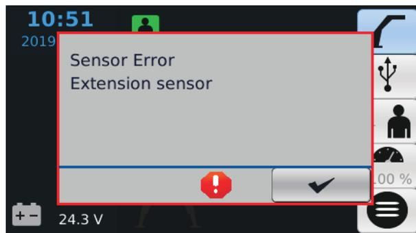
La fenêtre contextuelle de défaut informe l'utilisateur de l'emplacement où le défaut est détecté (levier de commande, vanne de contrôle ou alimentation).
