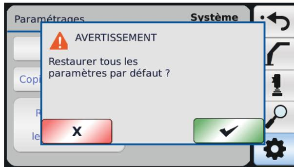
Tous les paramètres peuvent être réinitialisés aux paramètres d'usine. Cette réinitialisation ne devrait pas être effectuée à moins que tous les paramètres soient réellement inexacts pour une quelconque raison. La réinitialisation aux paramètres d'usine ne réinitialise que les paramètres de l'opérateur actuel.
