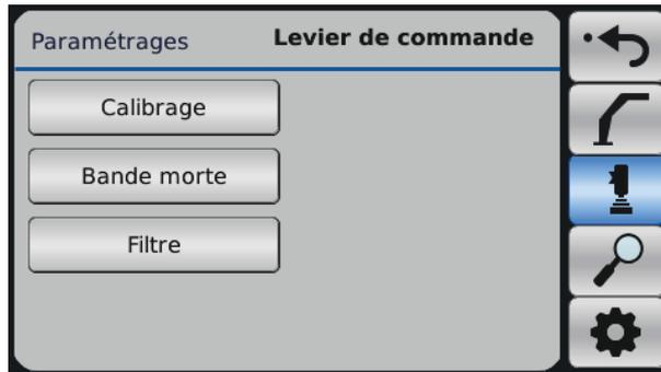
Dans le menu Paramétrages, le sous-menu Levier de commande se trouve sous l'icône de levier de commande.
