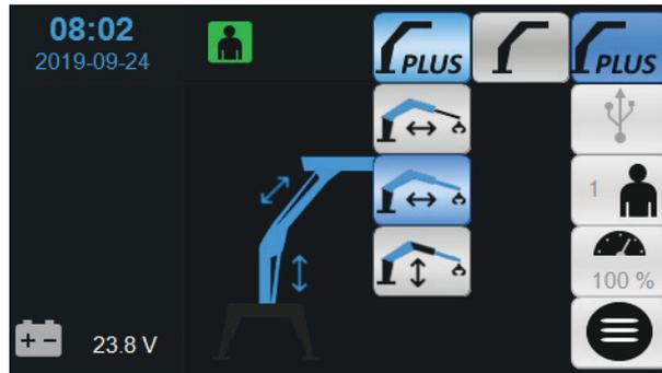
Le mode flèche parallèle avec extension automatique permet à l'opérateur de contrôler trois mouvements en même temps. Le contrôle est essentiellement le même que précédemment, mais avec le contrôle de l'extension en plus.
