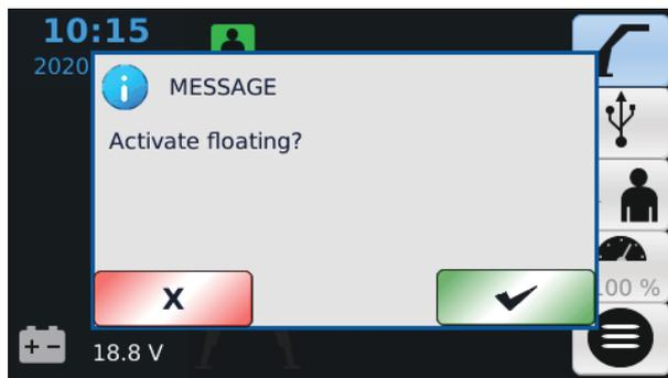
Cette fenêtre contextuelle apparaîtra si la confirmation de flottement est activée et si le flottement est activé. La demande de flottement peut être rejetée en appuyant sur le bouton « X ».
