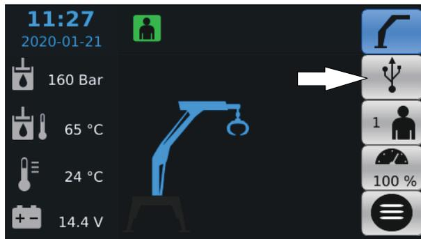
Si une clé USB est connectée et que le symbole est actif, il est possible d'accéder aux paramètres USB en appuyant sur le bouton du côté droit de la vue de travail.
