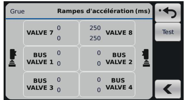
Les rampes d'accélération définissent la vitesse avec laquelle les valeurs de contrôle passent de vitesse min. à vitesse max. Plus la valeur des rampes est élevée, plus il faudra longtemps à la valeur de contrôle pour passer de vitesse min. à vitesse max.. Définir les rampes d'accélération de sorte que les mouvements de la grue soient fluides sans l'apparition de longs délais de contrôle.
