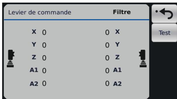
Cette fonction filtre les petites vibrations des leviers de commande qui se produisent quand la machine tremble dans l'environnement de travail. Les mouvements trop rapides générés par l'opérateur sont aussi filtrés. Plus la valeur est élevée, plus le signal entrant des leviers de commande est filtré.
