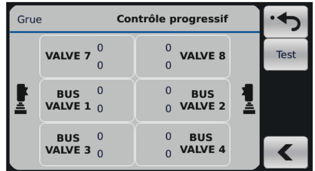
Avec le contrôle progressif, l'opérateur peut changer la linéarité du signal de contrôle.
