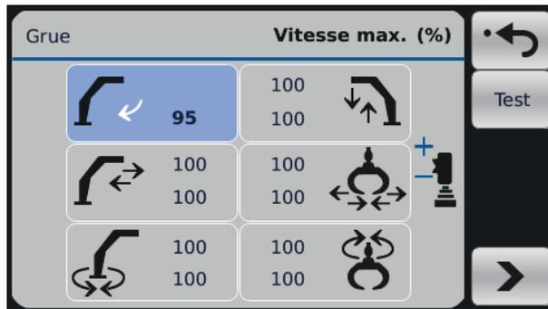
Dans l'exemple ci-dessus, l'opérateur a sélectionné la flèche secondaire en utilisation le levier de commande de gauche. L'opérateur est maintenant capable d'ajuster la vitesse max. de cette fonction en utilisant l'axe Z du levier de commande de droite.
