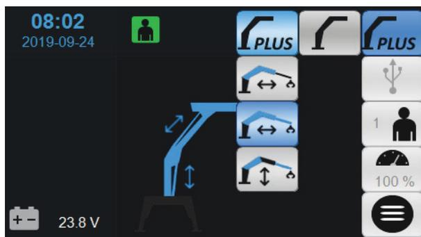
I det parallella bomläget med automatisk förlängning styr föraren tre rörelser samtidigt. Styrningen är i princip identisk med den föregående, men som tillägg finns styrning av förlängningsbommen.
