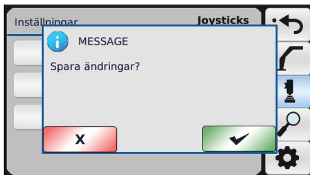
Användaren kan spara parametrarna genom att trycka på OK (grön knapp) eller ta bort gjorda ändringar genom att trycka på Avvisa (röd knapp). Efter att valen har sparats (eller avvisats) återgår skärmen till arbetsvyn.
