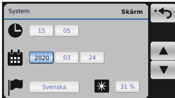
Ljusstyrkan justeras med ett glidreglage som visas när man trycker på knappen. Ljusstyrkan justeras med glidreglaget.
