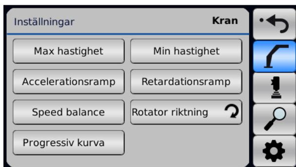
Rotatorns rotationsriktning kan ändras. Du applicerar ändringen genom att trycka på knappen. Pilen visar rotatorns riktning.
