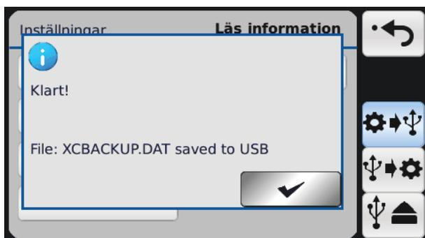
Efter funktionerna rekommenderas att man trycker på Mata ut USB innan USB-enheten tas bort. När man gör så kan användaren undvika skadade data konfigurerings-, parameter- och loggfilerna.
